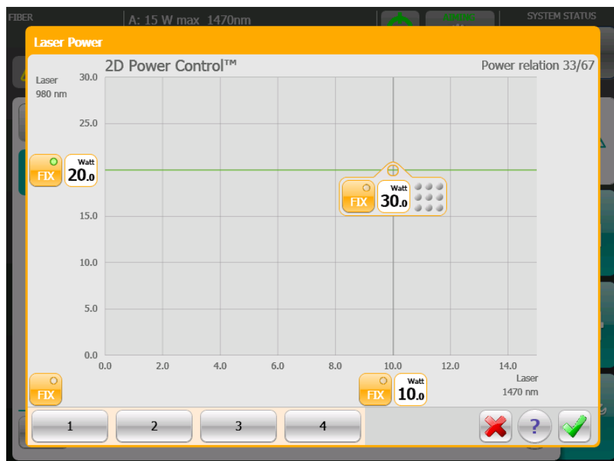
Kuva 26: 980 nm:n / 1 064 nm:n aallonpituuden tehon kiinnittäminen pystyakselilla.
