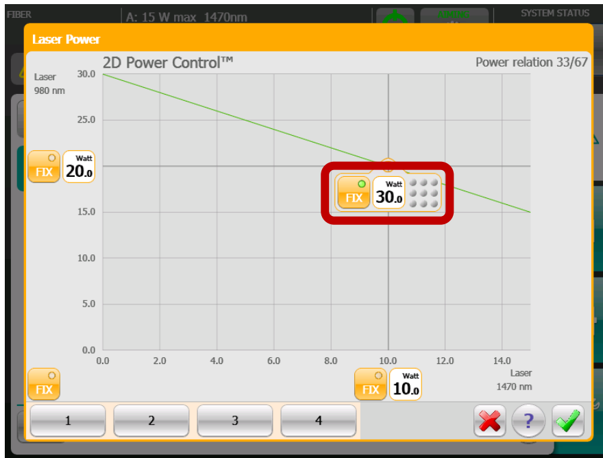
Kuva 23: Tehon asettaminen laserin kokonaistehon pysyessä vakiona.
